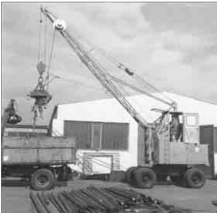
1962: Seilbetriebener S833 mit erhöhter Fahrerkabine
