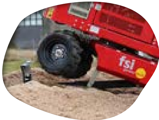
Hydraulisch verstellbares Planierschild
